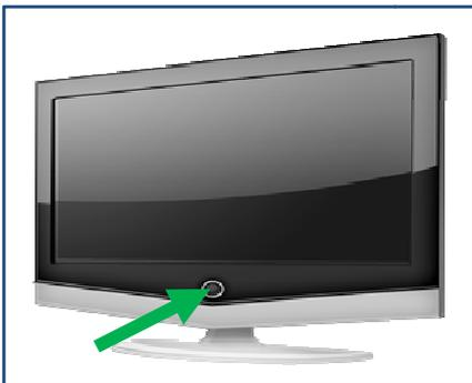
Figura I. 8. Botón de encendido del monitor.
